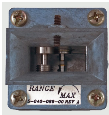
Cavità a 10Ghz con diodo gunn. Vista anteriore.
