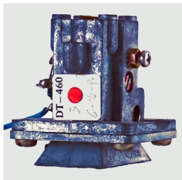
Cavità a 10Ghz con diodo gunn. Vista laterale con la vite di regolazione della frequenza.
