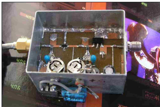
Slika 3 - Prvi prototip s klasičnimi trimmerji
