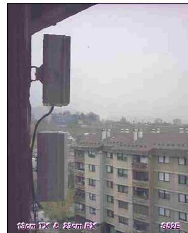
Slika 9 - TX, ojačevalnik in antena v eni skatli
