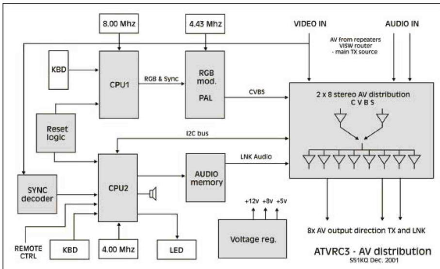
Slika 2 - Procesorski del z AV generatorjem
