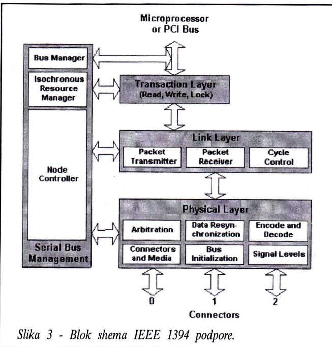
Slika 3 - Blok shema IEEE 1394 podpore.
